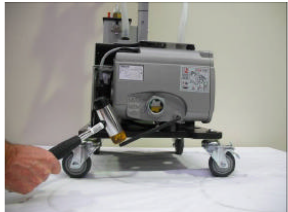
Ölablassschraube an Becker U4.20 Pumpe
